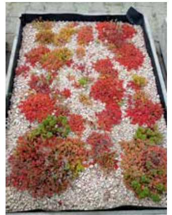
Vegetationssubstrate für Dachbegrünungen aus recycelten Kalksandsteinen
