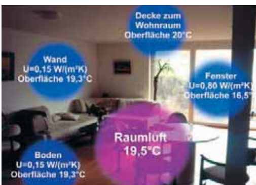
Temperaturen bei einem Gebäude mit guter Dämmung (bei Außentemperatur -10^\circ\text{C} )
