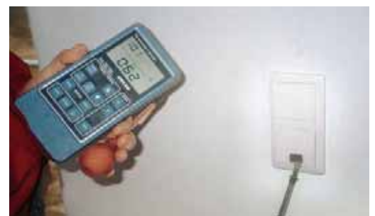
Steckdosentornado beim Blower-Door-Test
