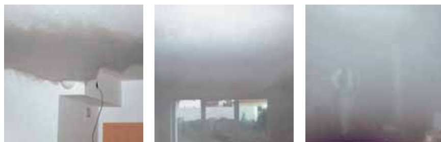
Nebelversuch zum Nachweis der gleichmäßigen Luftverteilung in den Räumen
